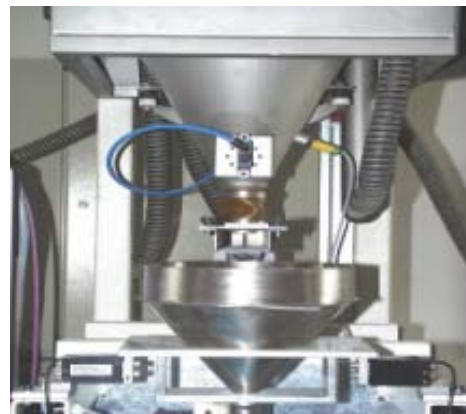
Gravimetrische Dosierung von Pulver
