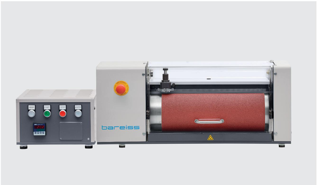
Mit der Abriebprüfmaschine bestimmen Sie die Abriebfestigkeit von Elastomeren durch Messung des Materialverlusts bei abrasiver Belastung. Das Prüfgerät führt die, je nach Modus, starre oder rotierende Materialprobe mit definiertem Anpressdruck über einen umlaufenden Schmirgelbogen und setzt sie damit einer reibenden Beanspruchung aus.
