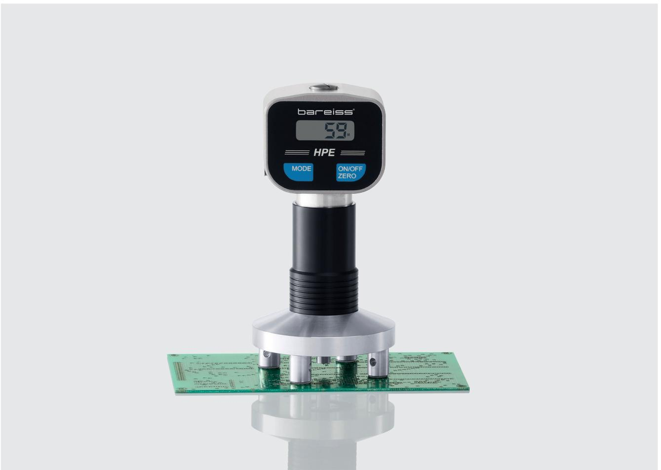
Die Härteprüfung an soliden Materialien wie glasfaserverstärkten Kunststoffen, Duroplasten, harten Thermoplasten und Leichtmetallen gelingt zuverlässig mit unserem digitalen Barcol Handhärteprüfgerät. Für korrekte Messergebnisse sind Probekörper mit einer planen Oberfläche und einer Mindestdicke von 1,5 mm notwendig.
