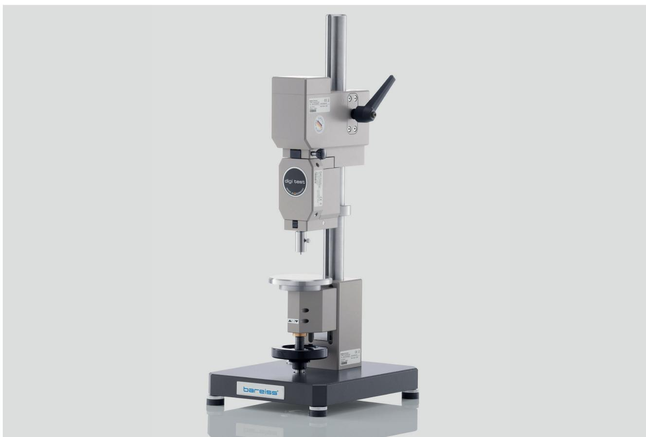
Das modulare digitest II bietet Ihnen höchste Flexibilität bei der Härteprüfung an Elastomeren, Polymeren und weichelastischen Materialien. In nur wenigen Handgriffen und ohne Werkzeuge lassen sich die verfügbaren Messeinrichtungen mit Eindringkörpern nach Shore, VLRH oder IRHD tauschen und erlauben so einen schnellen Wechsel zwischen unterschiedlichen Messmethoden.
