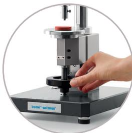
Höhenverstellbarer Aufnahmearm erlaubt leichte Anpassung an unterschiedliche Probengrößen
