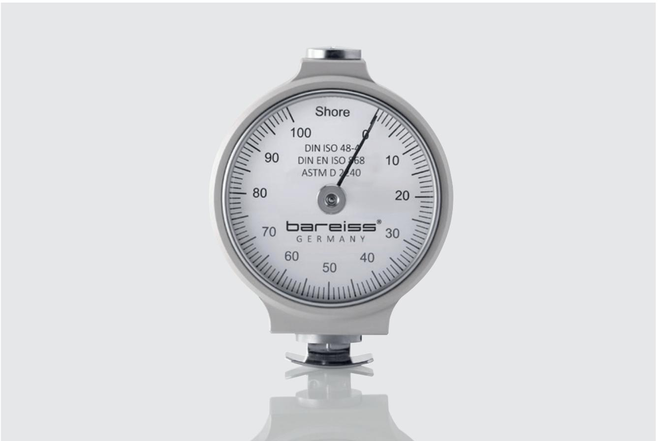
Der Härteprüfer dient zur Härteermittlung nach Shore an weichelastischen Materialien, Elastomeren und Kunststoffen. Für eine zuverlässige Härteprüfung nach Norm ist ein glatter und ebener Probekörper mit  $\geq 35$  mm Durchmesser und  $\geq 6$  mm Materialstärke vorgeschrieben.
