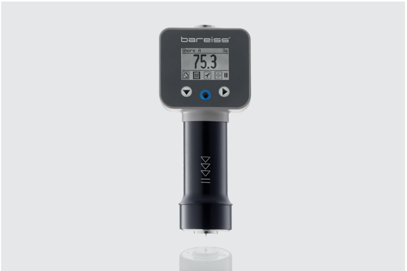
Unser Handhärteprüfgerät HPE III Basic steht für einfache, manuelle Shore-Härtemessungen an weichelastischen Materialien, Polymeren und Verbundwerkstoffen. Mit durchdachten Funktionen beugt es Bedienungsfehlern vor und lässt sich bequem handhaben.
