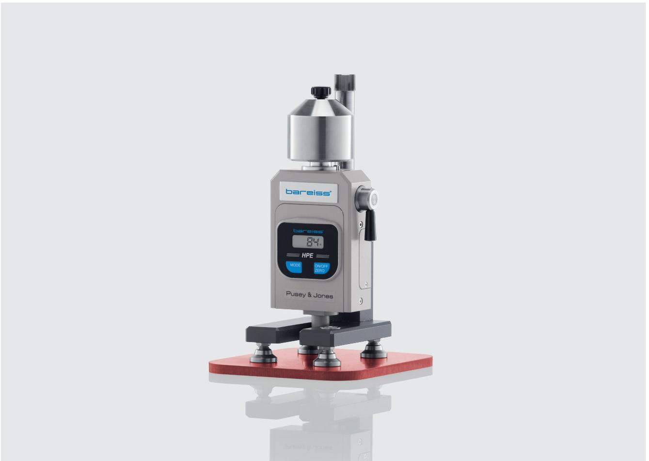
Das Härteprüfgerät Pusey & Jones ermittelt für Sie die Härte von Gummi und gummiähnlichen Materialien beschichteter Walzen ab einer Materialstärke von 13 mm.
