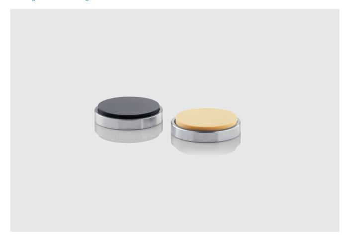
Zwischen den notwendigen Kalibrierintervallen stellen Sie mithilfe der Referenzelastomerblöcke die Messfähigkeit des Härteprüfgerätes sicher. Eine Vergleichsmessung an einem der kalibrierten Elastomerprüfkörper gibt Aufschluss über den Zustand des Eindringkörpers und den Messweg des Härteprüfers. Zeigt das Prüfgerät bei der Referenzmessung die korrekte Härte des Referenzelastomers an, so arbeitet es weiterhin zuverlässig.
