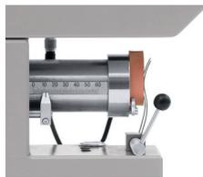
**Ambossplatte mit Auflegewinkel** für Schaumproben 80x80x50 mm nach DIN 53573
