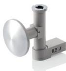
**Pendelhammer R40 mm** für Schaumstoffproben 0,2J - Form B nach DIN 53573
