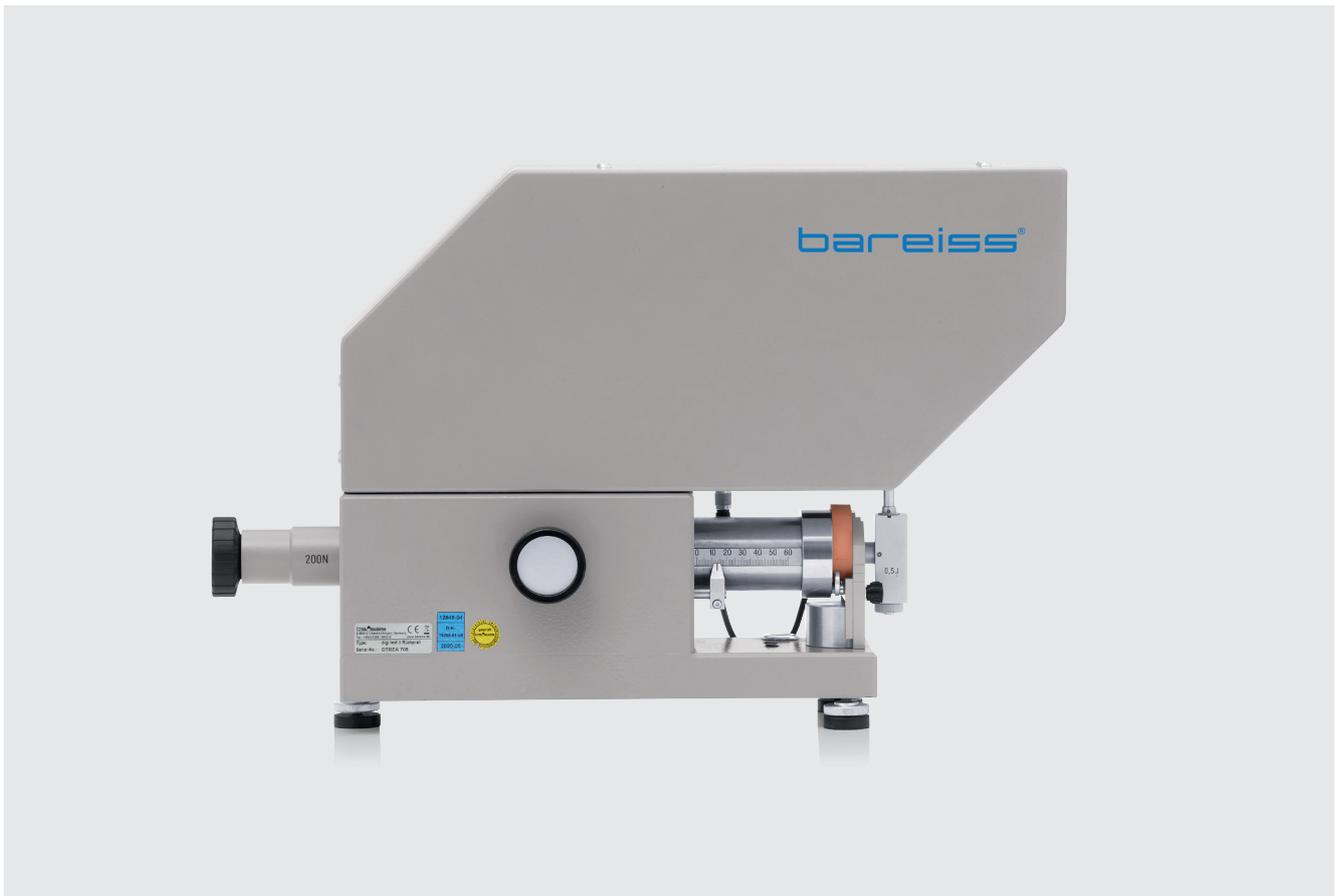
Das Rückprall-Elastizitätsprüfgerät ermittelt für Sie vollautomatisch und ohne Bedienerinfluss die Flexibilität von Elastomeren und ähnlichen Werkstoffen. Dank des optionalen Temperier-Moduls ermöglicht es auch Messungen an erwärmten Probekörpern und gibt damit Aufschluss über die Änderung des Elastizitätsverhaltens der Werkstoffe unter Temperatureinfluss.
