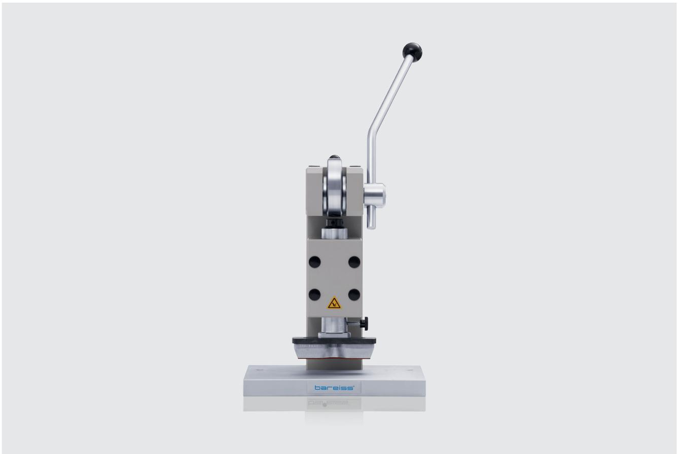
Mit der Einzelstanzpresse SP 1000 stanzen Sie Normprobekörper in kurzer Zeit und mit geringem Kraftaufwand aus Kautschuk, Elastomeren oder weich-elastischen Polymer-Schäumen.
