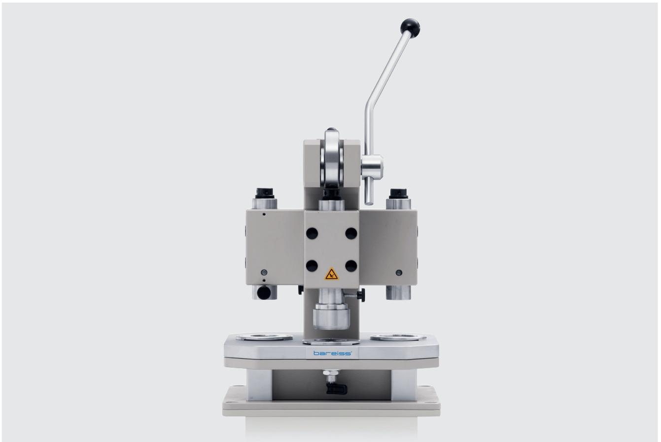
Die manuelle Stanzpresse SP 4000 hält zur Herstellung Ihrer Normprobekörper aus Kautschuk und elastischen Polymermaterialien gleichzeitig bis zu vier Stanzeinrichtungen bereit. Auf diese Weise wechseln Sie schnell zwischen unterschiedlichen Proben-Geometrien, ohne zuvor das Werkzeug auszutauschen.
